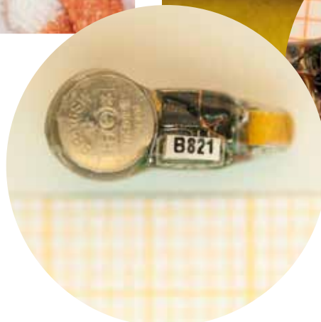
► Abb. 3: Hier sind telemetrische Sender in den Größen 11,7 x 5,0 x 3,8 Millimeter und 16 x 7,2 x 7,2 Millimeter zu sehen.
