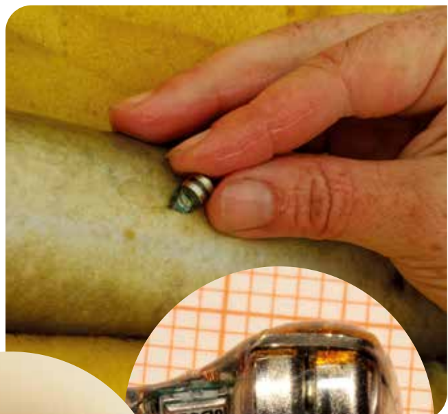
◀ Abb. 2: Die kleinen PIT Tags werden mit einer Kanüle unter die Haut eines Fisches injiziert (im Bild einem Aal); die Codierung wird mit einem Handlesegerät gescannt.
