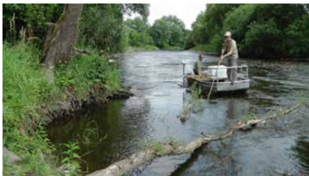
Vor und nach dem Totholzeinbau fanden 3D-Vermessungen statt um die Auswirkungen des Totholzes auf das Gewässer untersuchen zu können. (© G. Kemmler)
