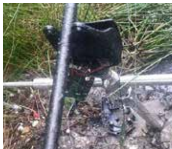
Einer der explodierten Bissanzeiger nach dem Blitzeinschlag (© E. Luettke / RhFV von 1880 e.V.)
