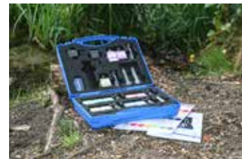
Mit dem DAFV-Wasseranalysenkoffer I ist eine schnelle Auswertung der wichtigsten Wasserparameter direkt vor Ort möglich
