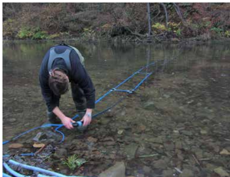
Installation der Leiterantennen (© Institut für angewandte Ökologie (IFÖ))
